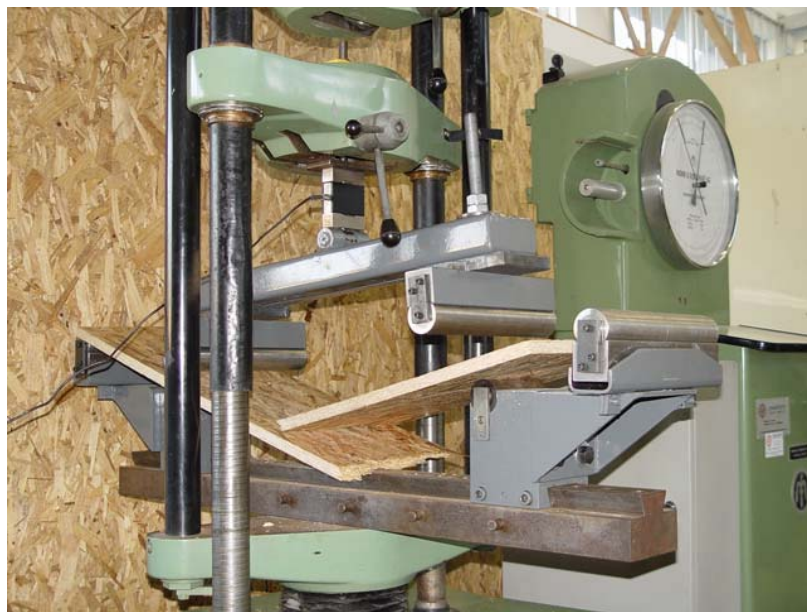
Figura 6 – Ruptura típica verificada no ensaio de flexão vertical.
