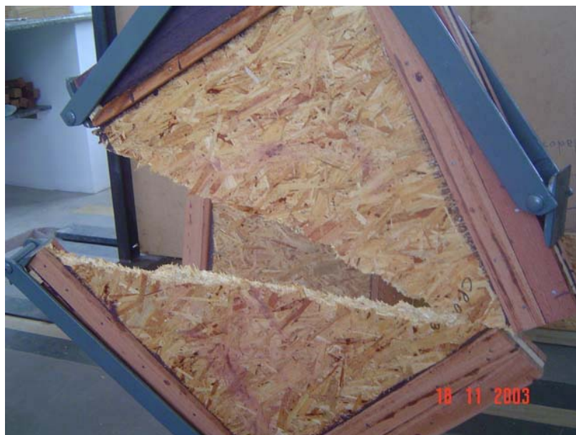
Figura 8 – Ruptura típica dos corpos-de-prova de cisalhamento ao longo da espessura.
