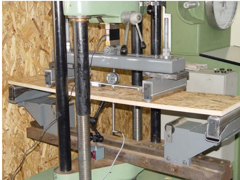
Figura 3a – Ensaio de flexão transversal e longitudinal.
